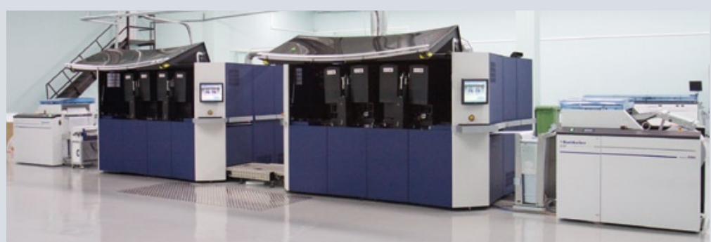
На производственной площадке Смоленского полиграфического комбината установлен современный комплекс оборудования для производства книг малыми тиражами: струйная печатная машина Xerox Impika Evolution, а также устройство размотки и намотки бумажного полотна Generation 6 и линия для рубки полотна на листы и формирования стопы от компании Hunkeler
