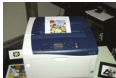
Рис. 7. Phaser 7100 — первый принтер в линейке Хегох для начального сегмента цветных принтеров формата А3. Разрешение цветной печати — 1200×1200 dpi. Скорость печати моно/цвет — 30/30 стр./мин. Стоимость страницы цветного отпечатка — примерно 4 руб., монохромного — 60 коп.
