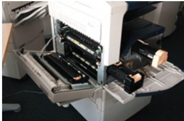
Рис. 3. Устранение замятия бумаги
